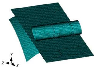
图 4 柔性拉形工艺 1/4 有限元模型
