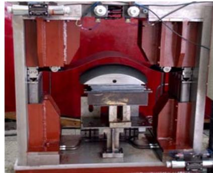
图 10 多辊下压式柔性拉形实验机照片
