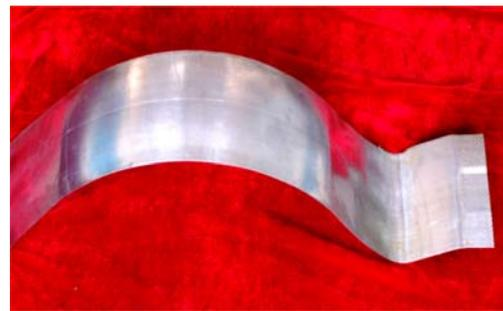
图 11 实验所得球面件
