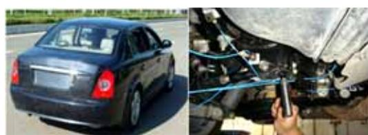
图 1 某轿车路试和锤击试验现场
