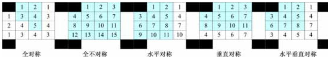
图 3 5 种对称插值滤波器
