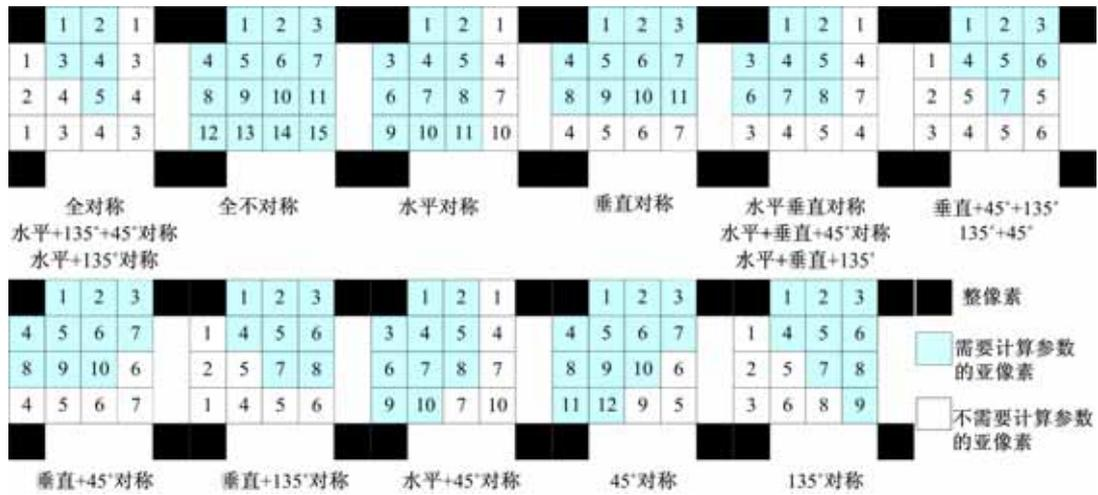
图 4 16 种对称插值滤波器
