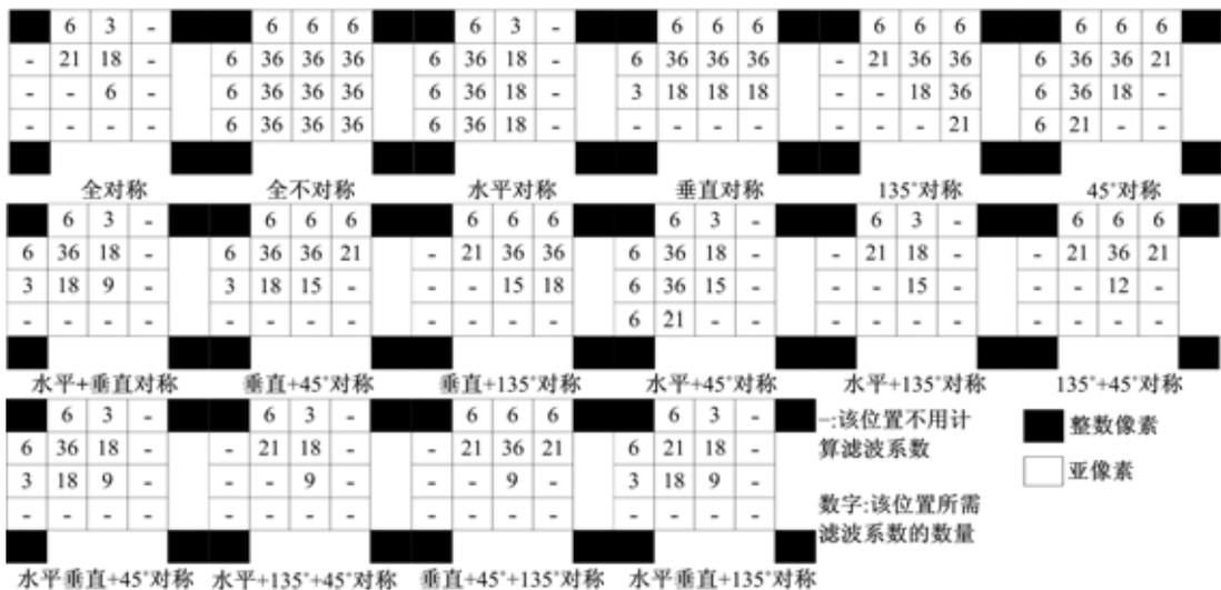
图 5 16 种对称性插值滤波器及其滤波系数数目
