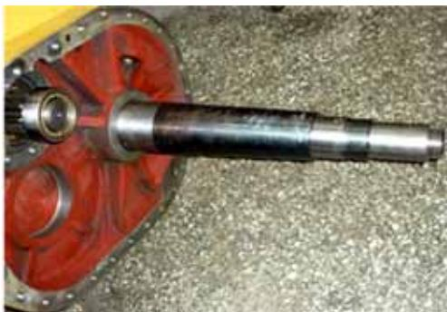
图 13 履带车辆改进后的终传动
