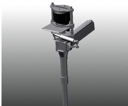
图 3 定义约束副后的转向系统模型
