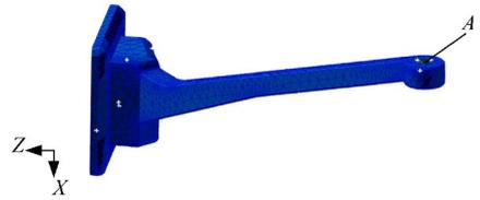
图 4 转向油缸固定支架柔性化处理
