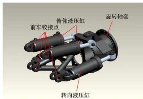
图 1 铰接机构的三维模型
