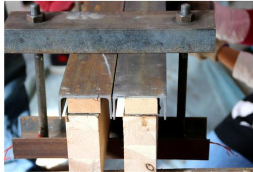
图 3 横向加压装置
