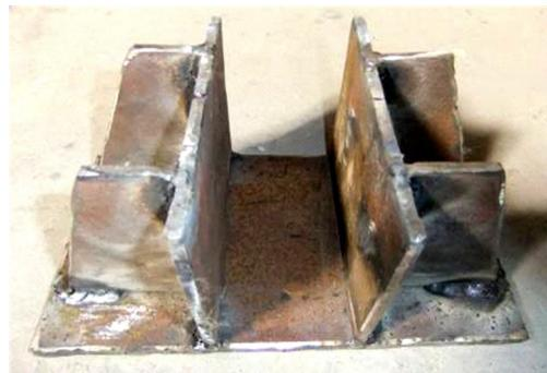
图 4 防侧向失稳装置
