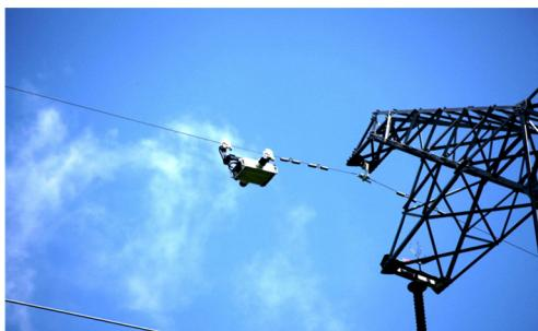
图 14 现场无动力下坡试验图
