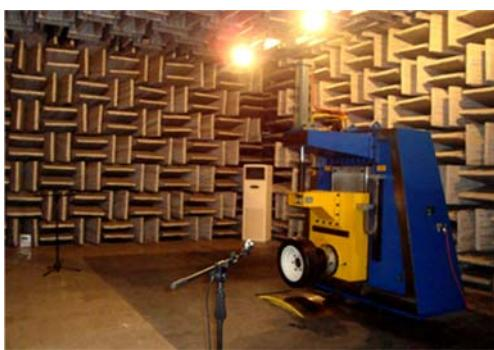
图 8 轮胎室内转鼓噪声测试示意图
