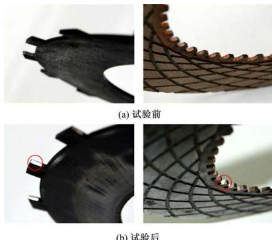
图 1 试验前、后键处磨损对比图
