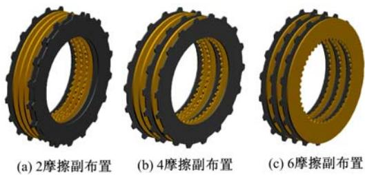
图 10 离合器摩擦元件布置形式
