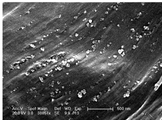
图3 EVA/纳米 $\text{TiO}_2$ 复合材料的FESEM照片
