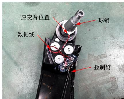
图 1 控制臂球头应变片安装示意图
