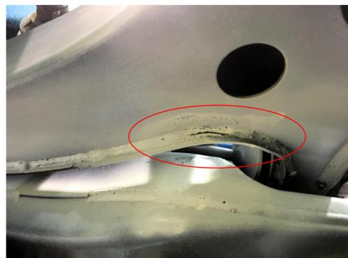
图10 整车24通道台架试验控制臂疲劳失效模式
