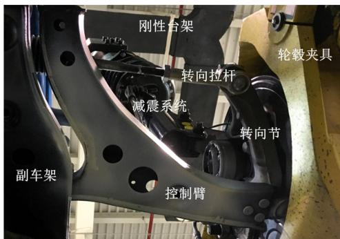
图9 整车24通道台架疲劳试验
